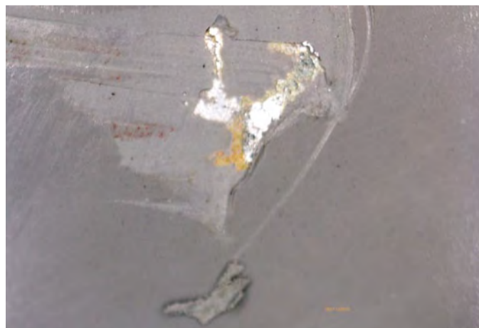
Unter der Beschichtung sind nach dem Anschneiden mit einem Skalpell „bräunliche“ Rückstände zu finden.
