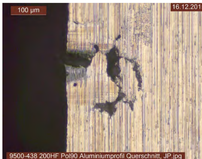
Mit dem Mikrotomschnitt konnte der Fehlerbereich im Querschnitt dargestellt werden.
