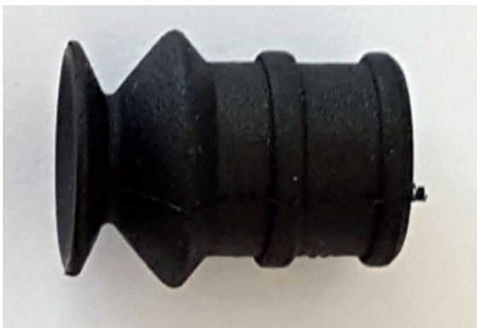
Abbildung 1: Kleines Teil, große Auswirkung: der eingesetzte Saugnapf aus dem Handlingsprozess des Beschichters.
