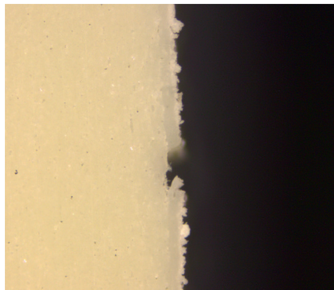
Abb. 4: Microtomschnitte zeigten die Fehlstelle wieder im Rohteil. Nun musste geklärt werden, warum das Fehlerbild nur auf lackierten Bauteilen, nicht jedoch schon auf dem Rohteil sichtbar war.
