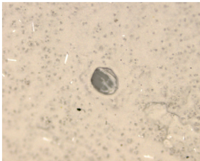
Abb.1: Die sogenannte „Kocher“ entstehen, wenn eine beschichtete Oberfläche zu schnell in den Ofen gefahren wird.
