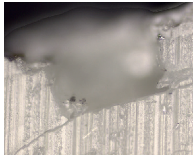
Abb.2: Nach der Erstellung eines Microtomschnittes zeigte sich, dass es sich um einen Rohteilfehler handelte.
