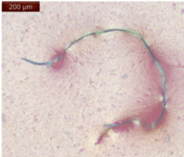
Abbildung 1 zeigt eine in die Pulverlackenschicht eingebettete Faser. Dies ist den DFO-Experten zufolge ein häufiger Beschichtungsfehler.
