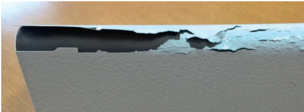
Bild 1: Bei einer Routineprüfung mit dem Dornbiegeprüfgerät platzte der Lack vom Werkstück ab.
