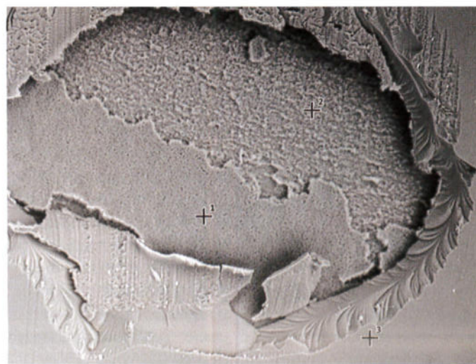
Bild 3: Nach dem Anschnitt der Blase konnte man mit dem REM eine weitere Schicht feststellen.
