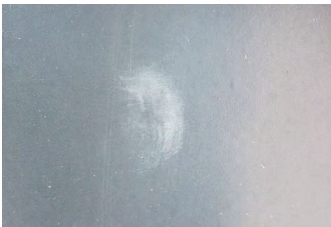
Bild 1: An einer pulverbeschichteten Toranlage zeigten sich Fleckenbildung bzw. Farbton- und Glanzverschiebungen. Fotos: DFO
