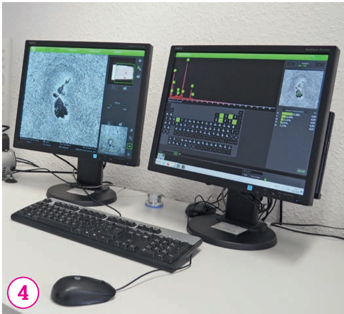
4 Die Untersuchung im REM und EDX offenbarte im Bereich des Einschlusses stark erhöhte Mengen an Chlor, links der Ausgabebildschirm des REM, rechts der Ausgabebildschirm des EDX.
