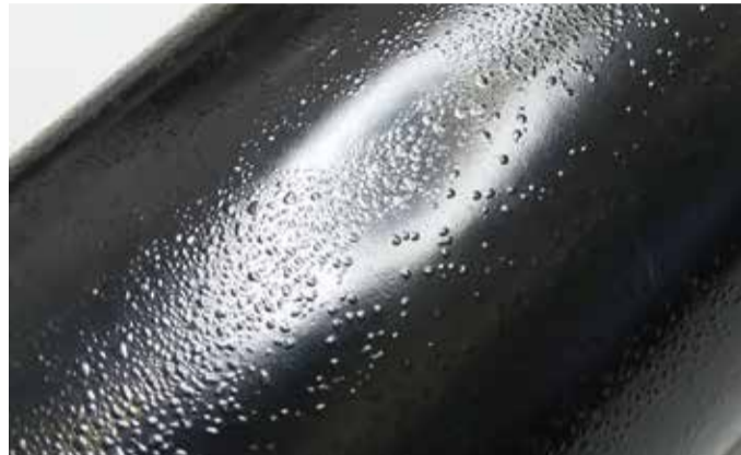
Abbildung 1: Blasenbildung war nach Kondenswasser-Konstantklima-Prüfung deutlich zu erkennen. Fotos: DFO
