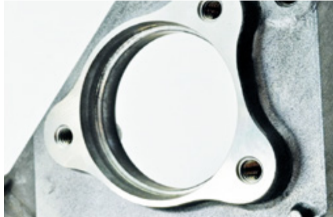
Abb. 1: Al-Druckguss-Flanschbereich nach Laser
