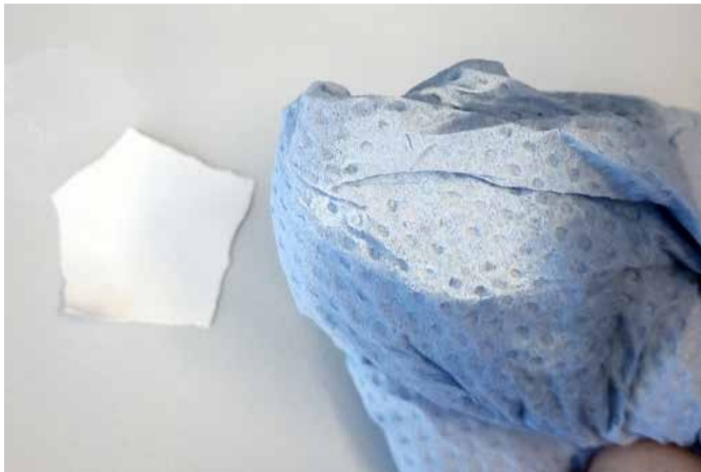
Abb. 1: Der Abwischversuch mit Isopropanol zeigt, dass die chemische Vernetzung mangelhaft ist.
