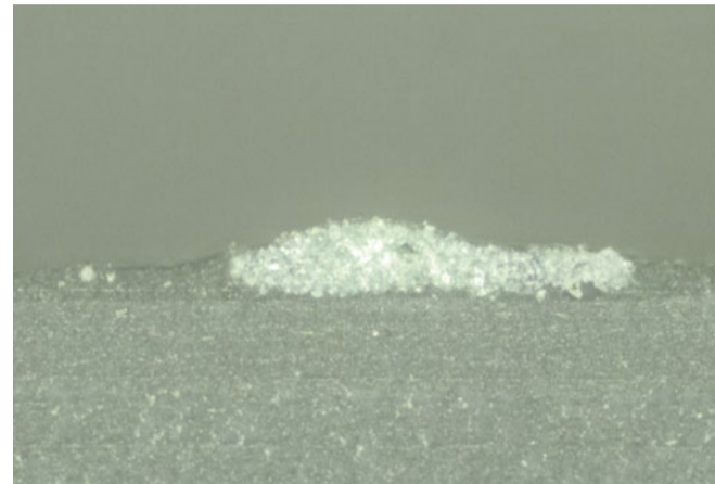
Abb. 2: Die Lichtmikroskopie des Querschnitts gibt Aufschluss über den Einschluss.
