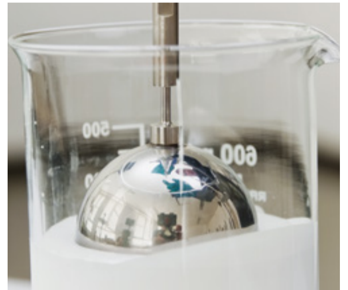
Die Dichte des Lacks kann relativ einfach bestimmt werden. Für Lacke sind die Methoden mittels Pyknometer oder Tauchkörper-Verfahren gemäß DIN EN ISO 2811-1 bzw. -2 ausreichend genau. Hier wird die Dichte mittels 100 ml-EIC-Kugel, Analysenwaage und Thermometer ermittelt. Fotos: Redaktion
