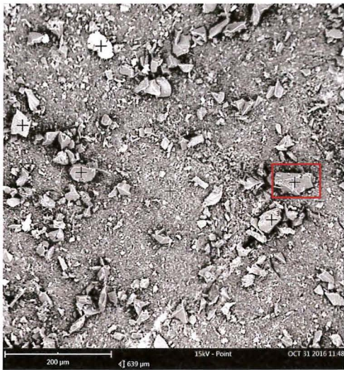
Bild 4 > REM Aufnahme und EDX Spektrum (rot markierter Bereich) der Unterseite der abgeplatzten Beschichtung
