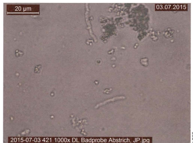
Bild 2 > Biologische Ablagerungen unter dem Lichtmikroskop mit 1000-facher Vergrößerung.
