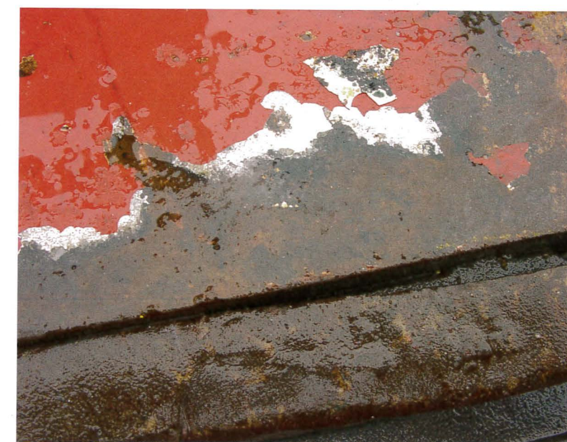
Bild 3 > Metallischer Glanz durch schützende Fettschicht
