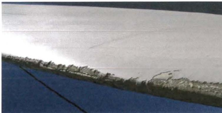
An beschichteten Rotorblattvorderkanten treten oft massive Schädigungen auf. Ursache ist eine Kombination aus Alterung der Beschichtung durch Witterungseinfluss und mechanischer Beanspruchung durch Regenerosion.
