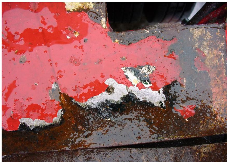
Fehlerbereiche mit abgeplatzter Beschichtung und stellenweise glänzender Substratoberfläche
