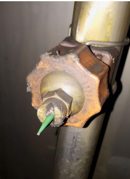
Verstopfte Spritzdüsen sind ein häufig auftretender Fehler in Durchlaufspritzanlagen.
