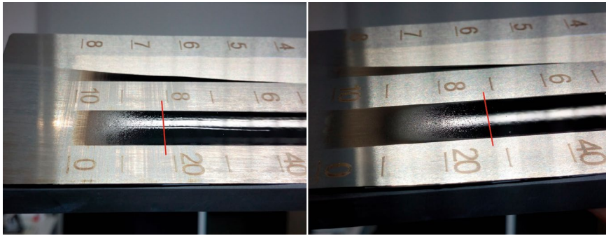
Bild 2 > Ergebnis des Grindometer-Aufzugs einer fehlerfreien Lackcharge (links) und der fehlerhaften Charge (rechts).
