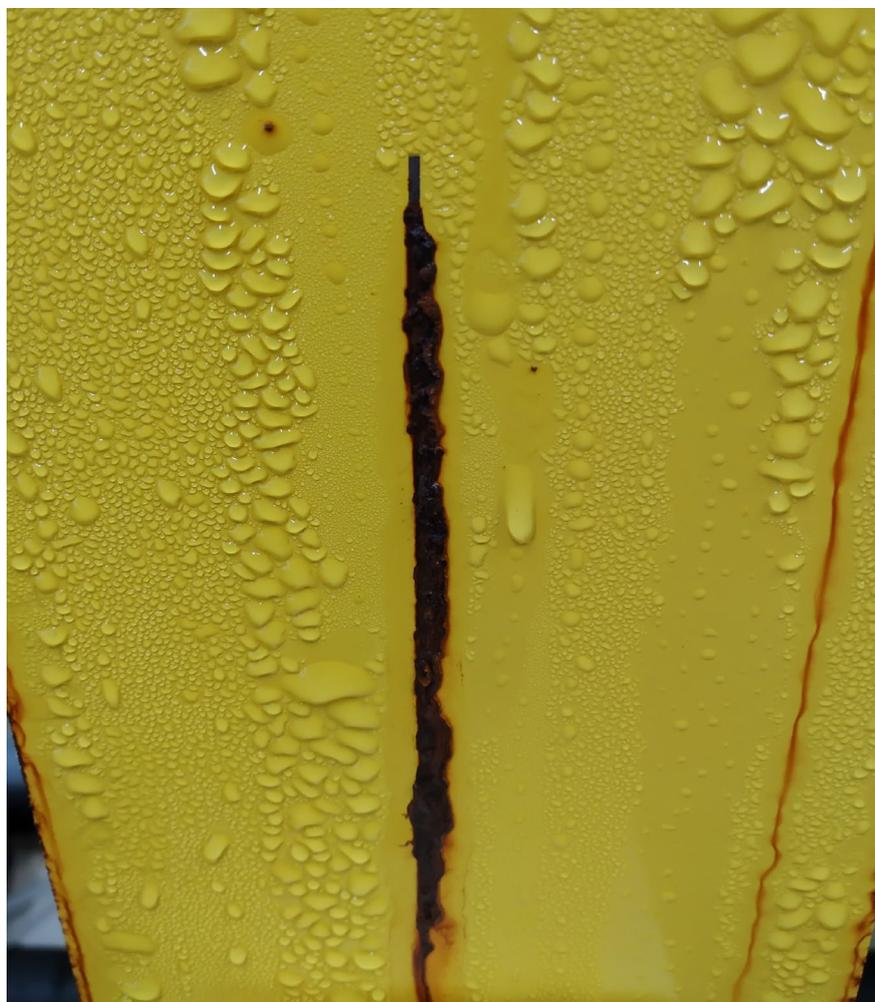
Korrosionsentwicklung an Ritzspur als Ergebnis einer Korrosionsprüfung.
