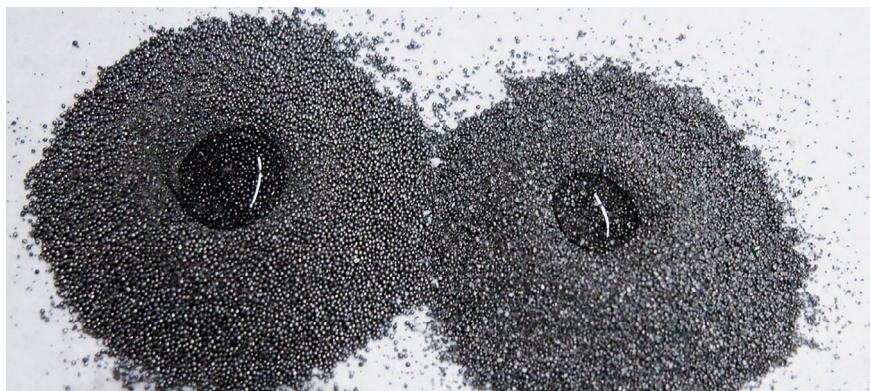
Bild 1 > Um zu prüfen, ob das Strahlmittel frei von Fetten und Ölen ist, kann man in eine aufgehäufte Strahlmittelprobe eine kleine Kuhle eindrücken und Wasser hineingeben. Läuft das Wasser ab, so ist dies ein Hinweis auf eine ausreichende Sauberkeit des Strahlmittels.
