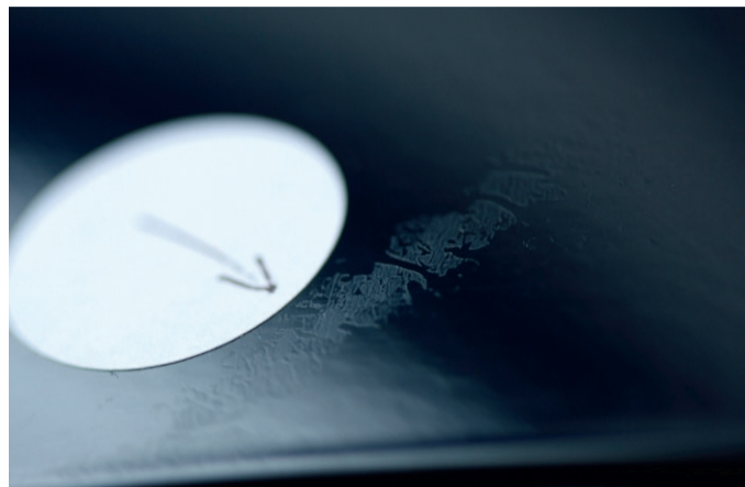
Bei der Verpackungsfolie zeigten sich Abdruckmarken.
