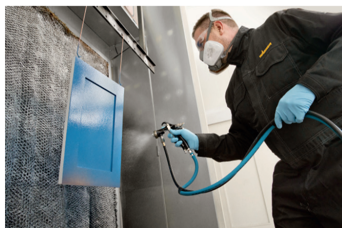
Die „GM 1030P“ ist mit neuen Features ausgestattet und eignet sich zum Applizieren von Grundierung, Füller, Klarlack oder Beize.
