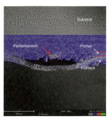
Von links nach rechts: Untersuchung der Fehlerstellen mit REM-Aufnahme, EDX-Mapping und ganz rechts ein im Primer lokalisierter Partikel.
