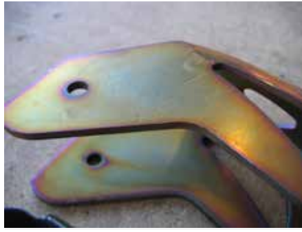
Abb. 1 (oben links): Pulverbeschichtetes Bauteil mit Oberflächenstörungen.
