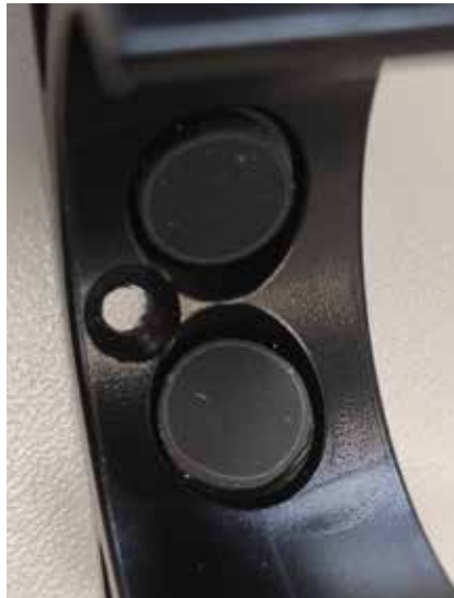
Abb. 3: Die Kontaktstellen der Kunststoffeinslagen mit den Rohren stimmten exakt mit den Fehlerbereichen überein.
