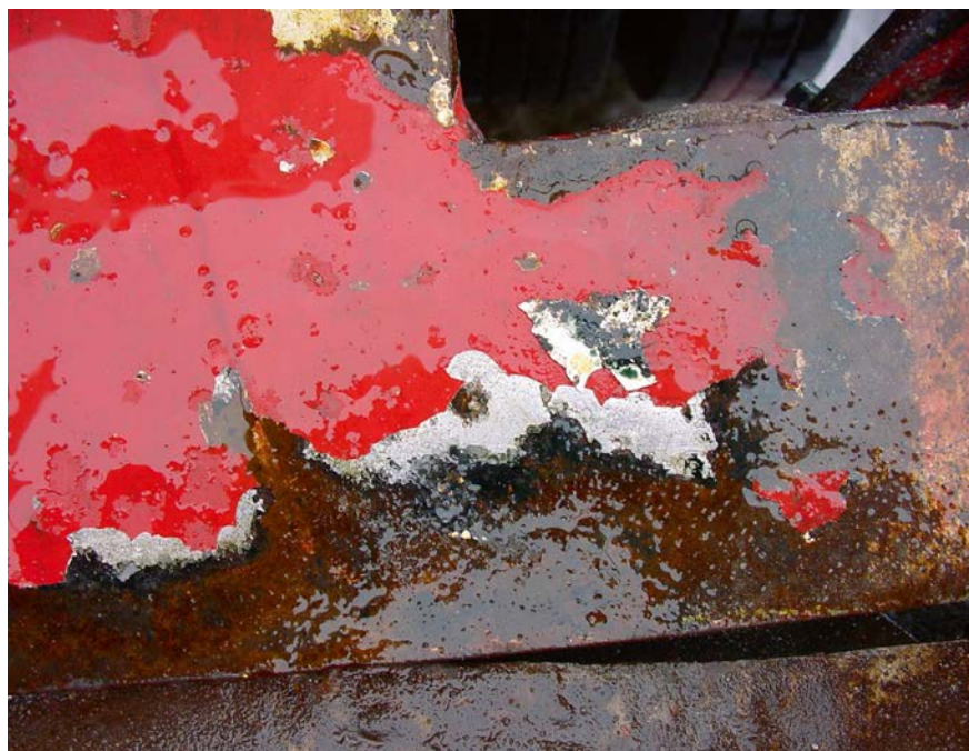
Bild 1 > Infolge der Ablösung der Beschichtung kam es zu Korrosionserscheinungen an den freiliegenden Stahlflächen. Im Bereich der (noch) blanken Stellen „schützen“ Fettrückstände
